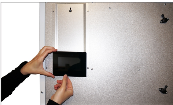
3. Irroita kosketusnäyttö painamalla pohjassa olevaa salpaa.
