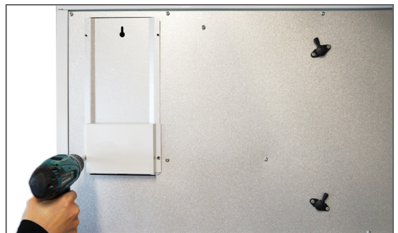
8. Suojapelti asennetaan etukannessa olevan reiän peitoksi. Etukansi kiinnitetään paikalleen ja sen yläosan 2 ruuvia kiinnitetään takaisin.
