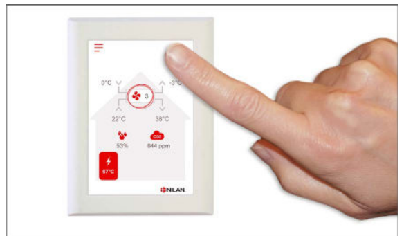
8. Käynnistä laite Paina hälytykset valikossa hälytyskuvaketta näytön oikeassa yläkulmassa ja kuittaa hälytys.
