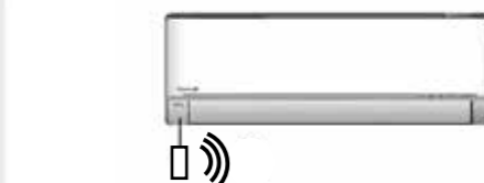
Wifi-sovitin CZ-TACG1 asennetaan pumppun sisään tai viereen.
