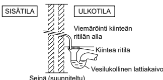
Kaavio tyhjennysletkusta rakennuksen ulkopuolelle.
